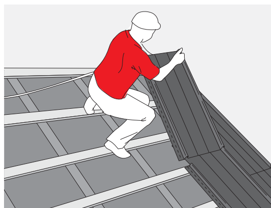
RYS. 27. UKŁADANIE KOLEJNEGO PANELU NA ZAKŁAD
