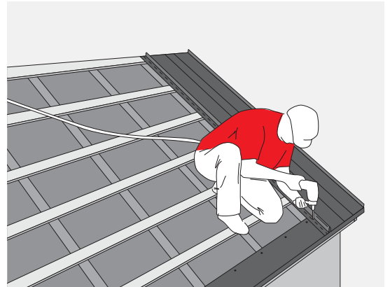
RYS. 18. PRZYTWIERDZANIE PANELU DO POŁACI
