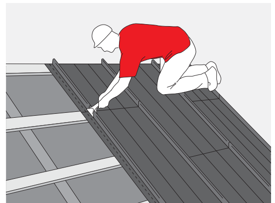
RYS. 30. ZACISKANIE ZAMKA PANELI W ZAKŁADACH
