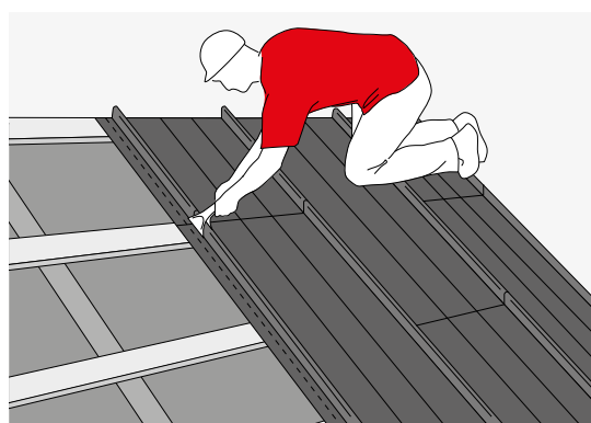
OBR. 30. ZAMYKÁNÍ ZÁMKU PANELŮ V PŘEKRYTÍCH
