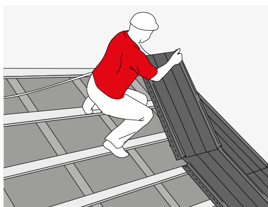
OBR. 33. PŘEKRYTÍ PŘI SPOJOVÁNÍ PANELŮ NA DÉLKU
