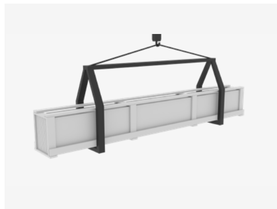
OBR. 5. VYKLÁDKA STŘEŠNÍCH PANELŮ
