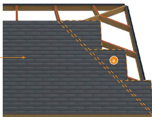
a Plokščių pjovimo linija
