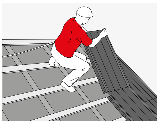
RYS. 27. UKŁADANIE KOLEJNEGO PANELU NA ZAKŁAD
