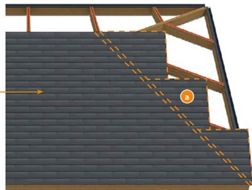
a Linia cięcia paneli
